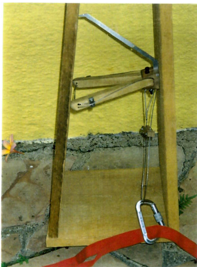
Figura VII.14: Modelo Funcional: fenda que se abre de cima para baixo, caso crítico.
