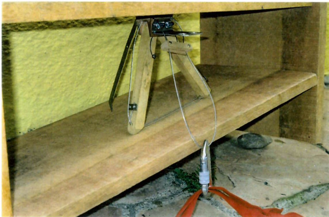
Figura VII.15: Modelo Funcional: fenda horizontal de faces não paralelas.
